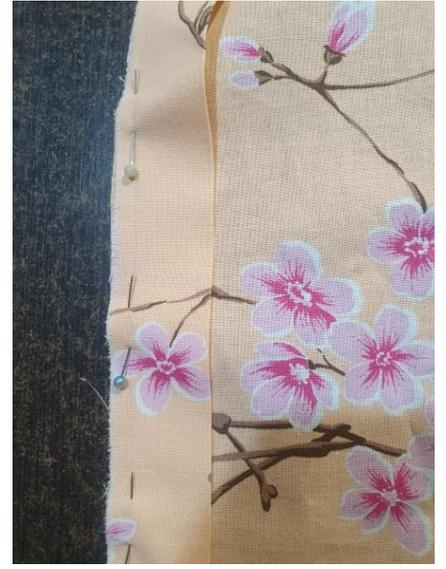
Соединить борта с обтачкой машинной строчкой, удалить сметочную строчку, припуски шва обметать, шов отутюжить
