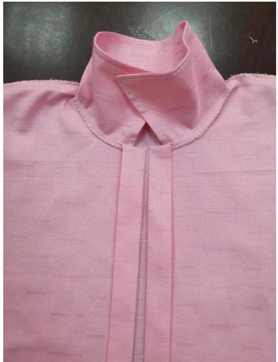
4. Шов отстрочить, отвернув припуск шва в сторону горловины.
